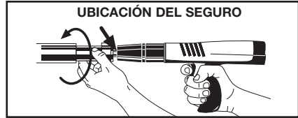
DESATORNILLE EL MANGUITO DE RETENCIÓN DEL CAÑÓN
