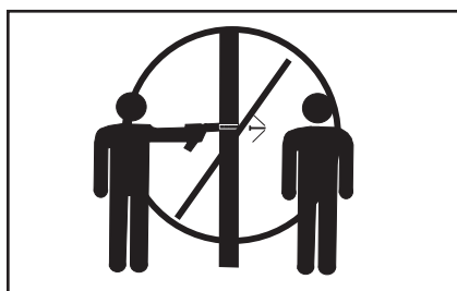
NUNCA INTENTE REALIZAR FIJACIONES SOBRE MATERIALES BLANDOS TALES COMO PAREDES DE YESO
