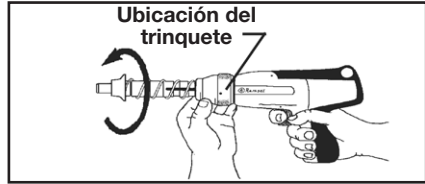
DESTORNILLE EL COLLARÍN DE RETENCIÓN DEL CAÑÓN
